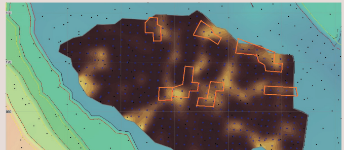
Рис. 6. Сопоставление положения рудных тел по данным геологической разведки с распределением средней энергоемкости бурения на руднике Куранах. Сурет 6. Куран кен орнында бұрғылаудың орташа энергия сыйымдылығын үлестірумен бірге геологиялық барлау деректері бойынша кен орны денелерінің орналасуын салыстыру.
